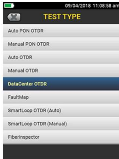
DataCenter OTDR Mode
